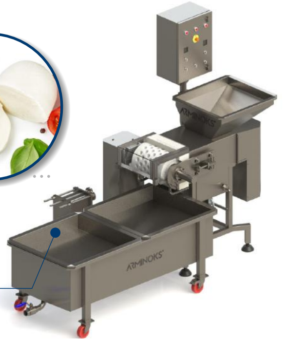
Çoklu Kalıplı Kaşar Gramajlama Makinası Carousel Cheese Moulder
